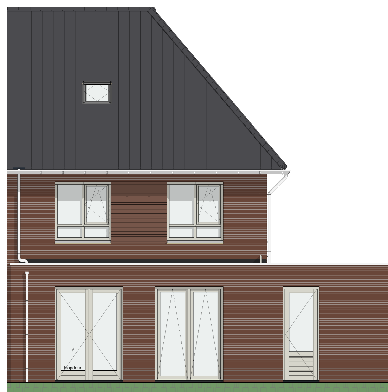
OPTIE M.4.8.02 - UITBREIDING AAN DE ACHTERZIJDE 1,43m
